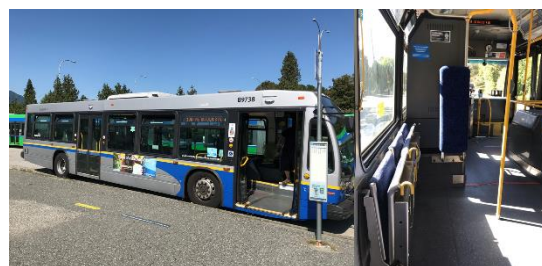
図1. 低床バス(左) 跳ね上げ式座席と車椅子スペース(右)
